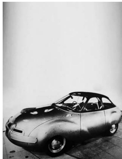
Pangard La Dynavia, voiture expérimentale en tôle d'acier emboutit 1948
